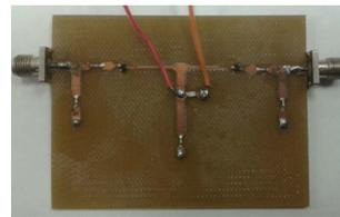
Fig. 2. The fabricated rectifier.
