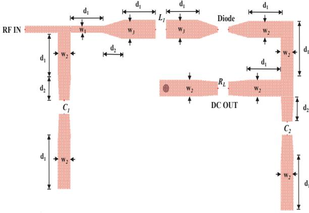
Fig. 5: The rectifier layout.
